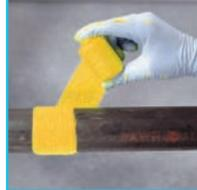
Szivárgó csővezetékek ideiglenes/közepes távú javítására. Maximális hőmérséklet 120 °C. A készlet tartalma: védőkesztyű, Loctite® 3463 és uretánnal impregnált üvegszál erősítésű műanyag szalag.
