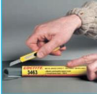
Acéltöltésű kenhető rúd. Nedves felületre tapad, víz alatt is kikeményedik. Vegyi anyagoknak és korróziónak ellenáll. Fazékidő 3 perc, kikeményedés 10 perc. Fúrható, reszelhető és festhető.
