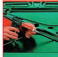
Kemény – rugalmas ragasztóanyag egyszerű adagolással: közvetlenül a statikus keverővel ellátott ikerkartusból. Nagyszilárdságú, vegyileg ellenálló. Átfesthető.
