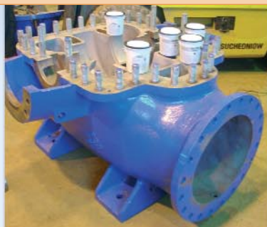
2. kép: A felület szemcsecszórás után 75 µm-es profilt kapott
